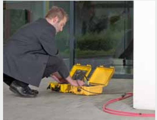
Abb. 3: Ableitstrommessung an einem Gebäudeteil
