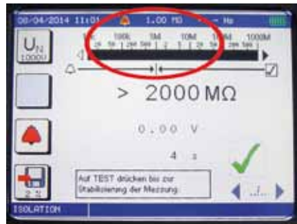
Isolationsmessung bewertet mit aktuellem Grenzwert von 1 MΩ
