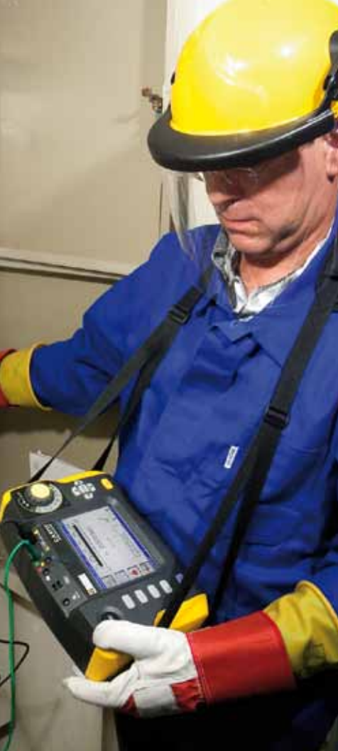
Messtechnische Überprüfung mit dem Installationstester C.A 6117
