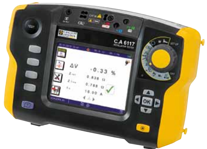
Ergebnis bei der Messung des Spannungsabfalls
